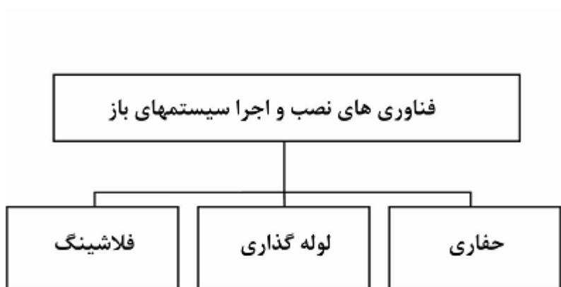
شکل (۴-۵) - درخت فناوری بخش نصب و اجرا سیستم‌های باز پمپ‌های حرارتی زمین گرمایی
